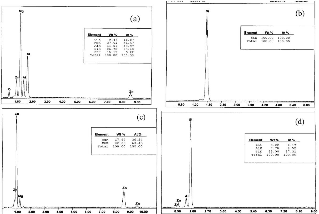
Fig. 4. EDAX spectrum of (Mg<sub>2</sub>Si + Si)/ZA27 composites. (a), (b), (c) Inner layer, (d) outer layer.
