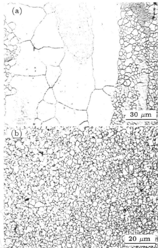
图 2 ZK60 镁合金经 350 °C 往复挤压 (CEC) 变形前、后的显微组织
